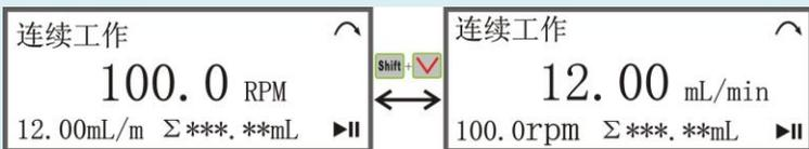
(五) 泵停止时，按 **Shift** + **Max** 键总量清零。
