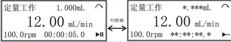
注：① “PC”代表“Personal Computer”即由计算机等控制。②通讯方式启动泵后，按面板
