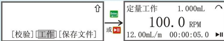
**1.000mL：**目标装量，输出的装量，工作时倒计时显示。
